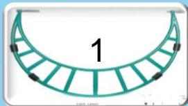
1、对操作人员的要求比较严格，初学者很难测量准确，特别是直径超过300mm的版辊；
